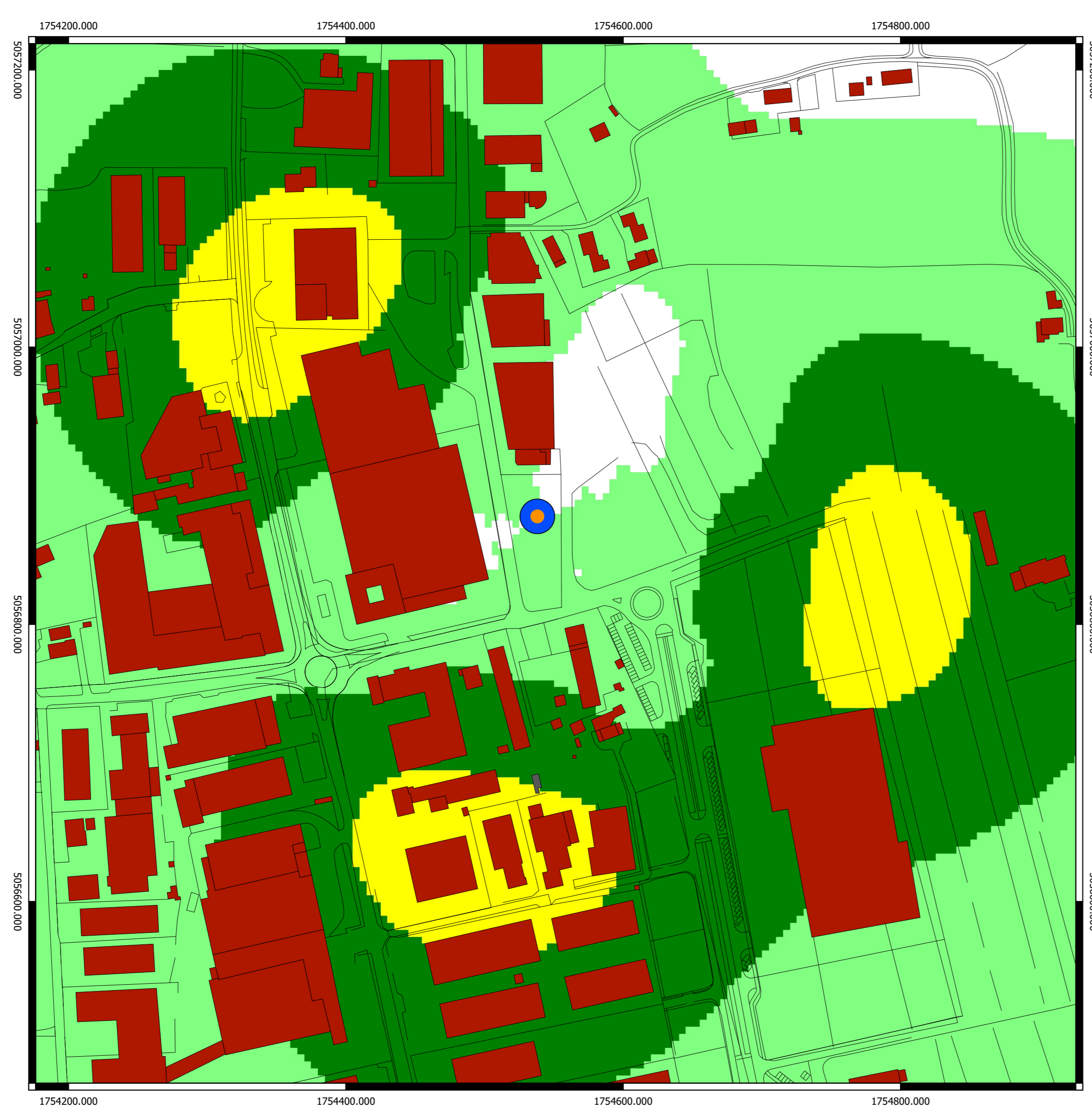
Campo elettromagnetico (V/m) calcolato alla quota di 2 m sul livello del terreno
